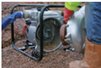
Der abnehmbare Inspektionsdeckel ermöglicht einen leichten Zugang
