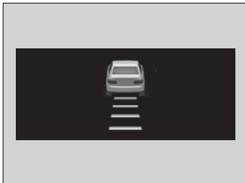
1 Erfassungsbereich der ACC mit Stauassistent zur Geschwindigkeitsregelung LSF (Low Speed Follow): 120 m
